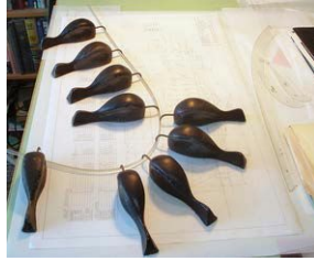
Figura 4-11. Os splines foram criados originalmente usando madeira dobrável e “patos”, e eram usados como uma ferramenta para projetistas ajustarem curvas. Foto cortesia de Bob Perry
