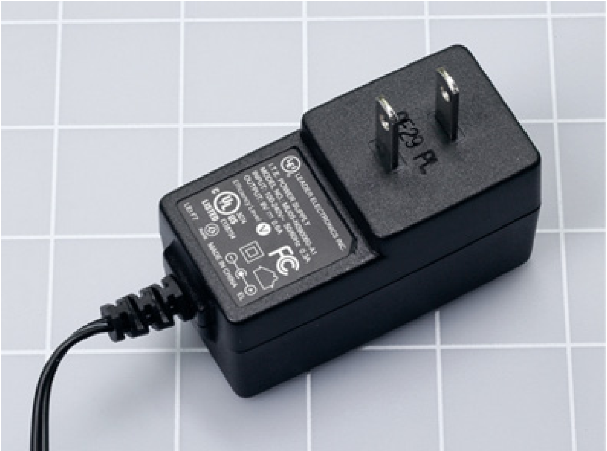
Figura 3.2 – Um adaptador AC que fornece uma saída fixa de 9 volts DC.
