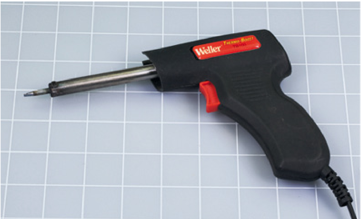
Figura 3.4 – Um ferro de solda Weller Therma-Boost de 30 W pode ser útil em tarefas com fios mais grossos e componentes maiores.
