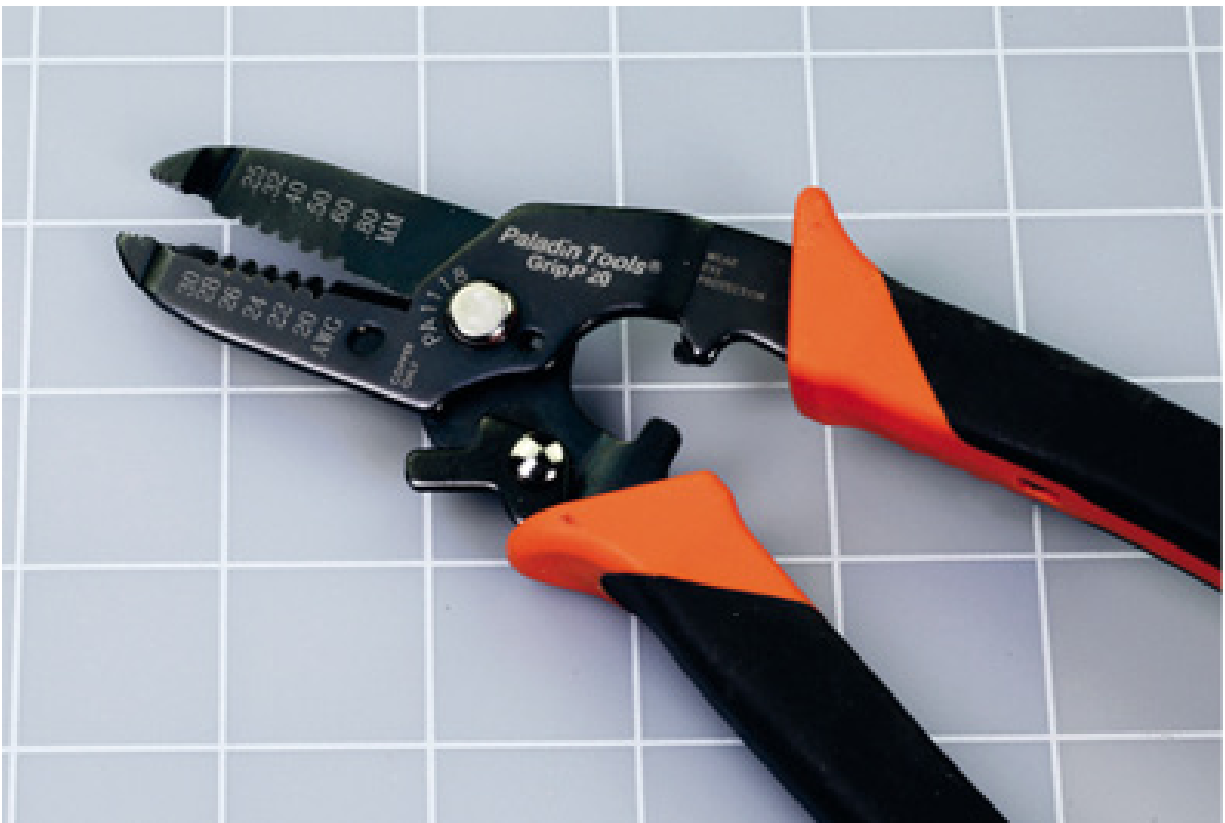
Figura 2.8 – Os desencapadores de fio recomendados são projetados para fios de espessura entre 20 e 30 AWG.
