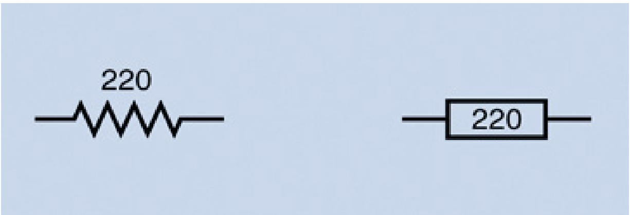
Figura 2.44 – Símbolo de um resistor nos Estados Unidos (esquerda) e Europa (direita).
