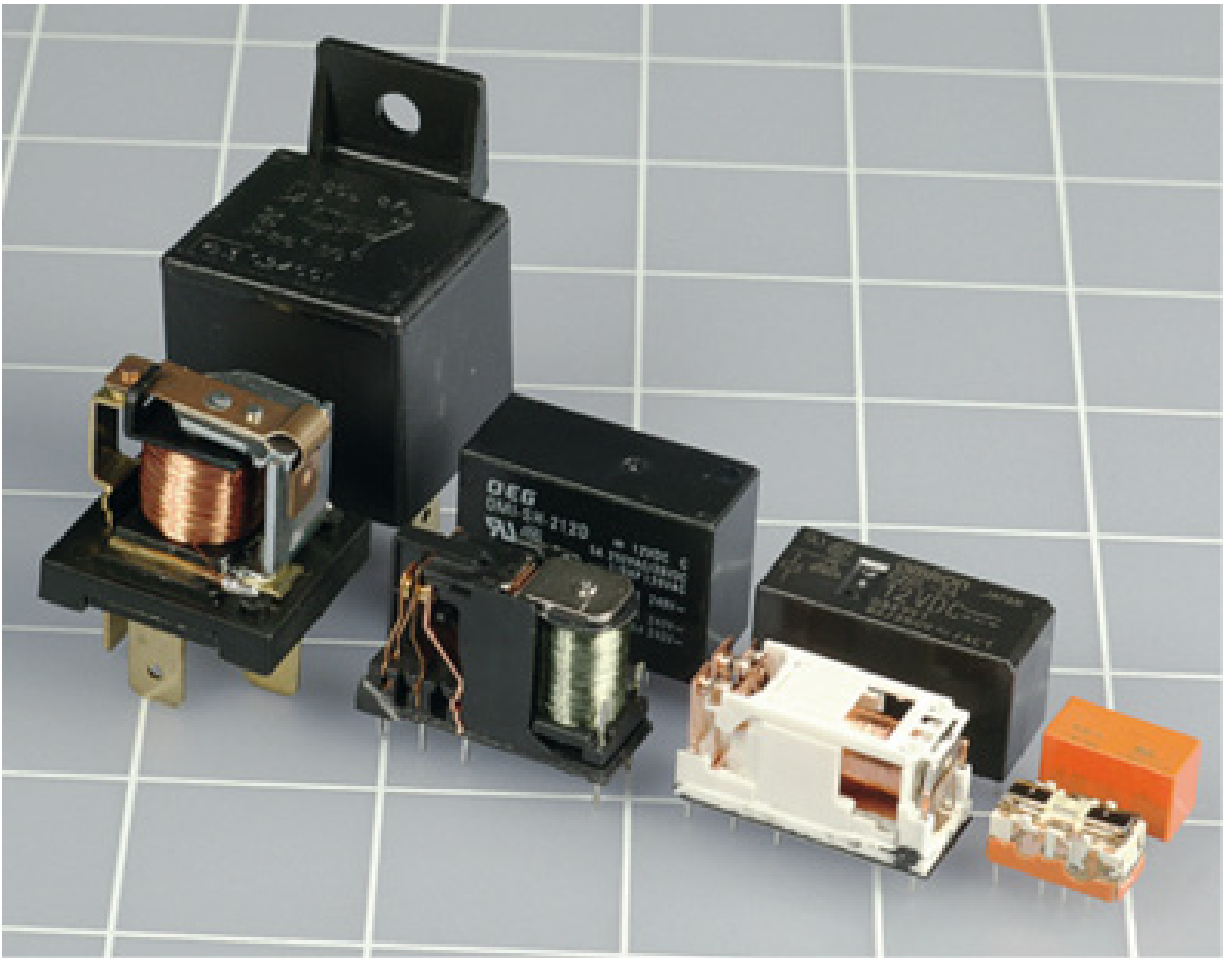
Figura 2.61 – Uma variedade de relés de 12 volts. Veja texto para detalhes.
