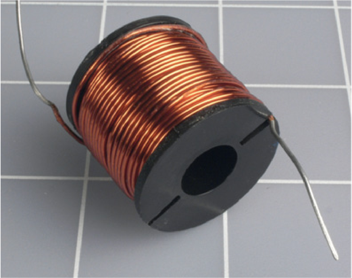
Figura 5.55 – A fita preta é removida, revelando uma bobina de fio magnético.
