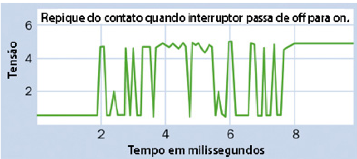
Figura 4.127 – Flutuações criadas pela vibração dos contatos quando um interruptor é fechado. (Derivado de especificações da Maxim Integrated corporation.)
