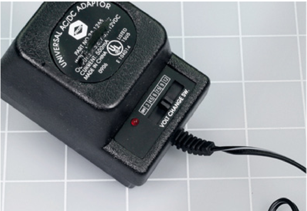
Figura 3.1 – Este adaptador AC se encaixa na tomada da parede e oferece uma gama de opções de tensões DC por meio de uma pequena chave.
