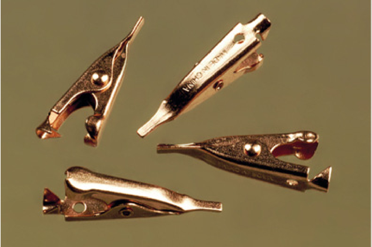
Figura 3.20 – Estes pequenos cliques de cobre absorvem o calor para proteger os componentes quando você os está soldando.
