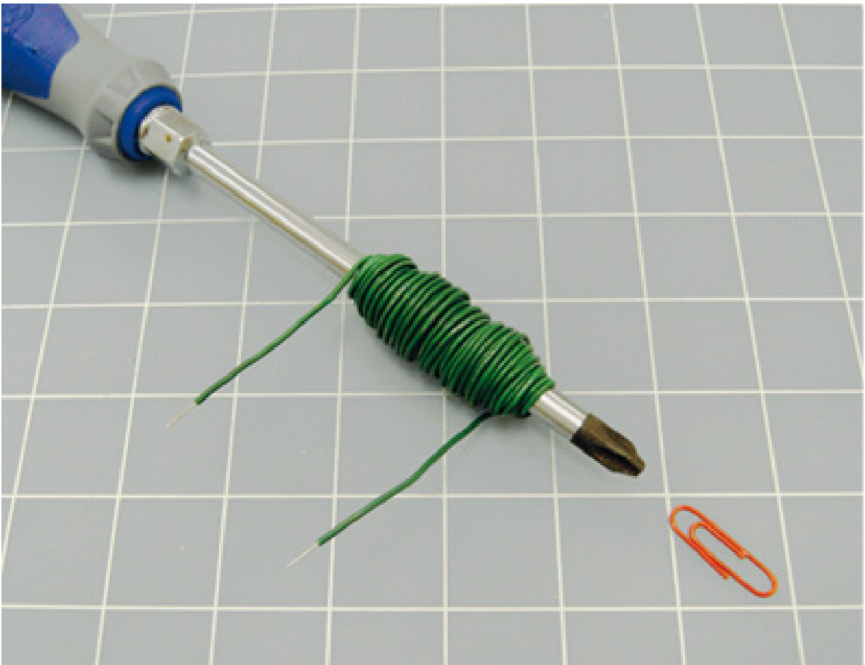
Figura 5.9 – Este eletroímã é o mais básico e é potente o suficiente para atrair um clipe de papel.
