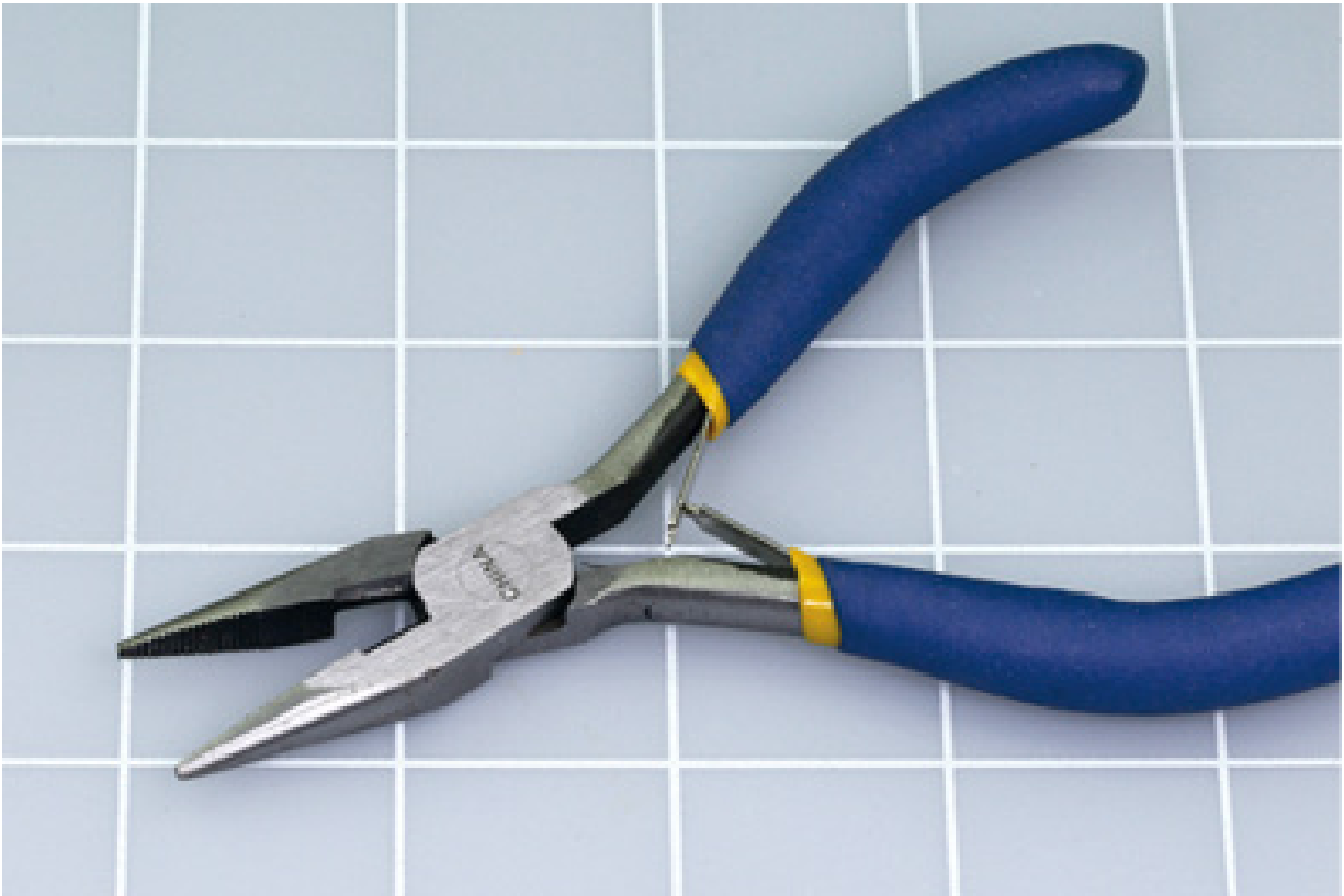
Figura 2.2 – Alicates adequados para trabalho em eletrônica não devem medir mais de 12,5 cm.
