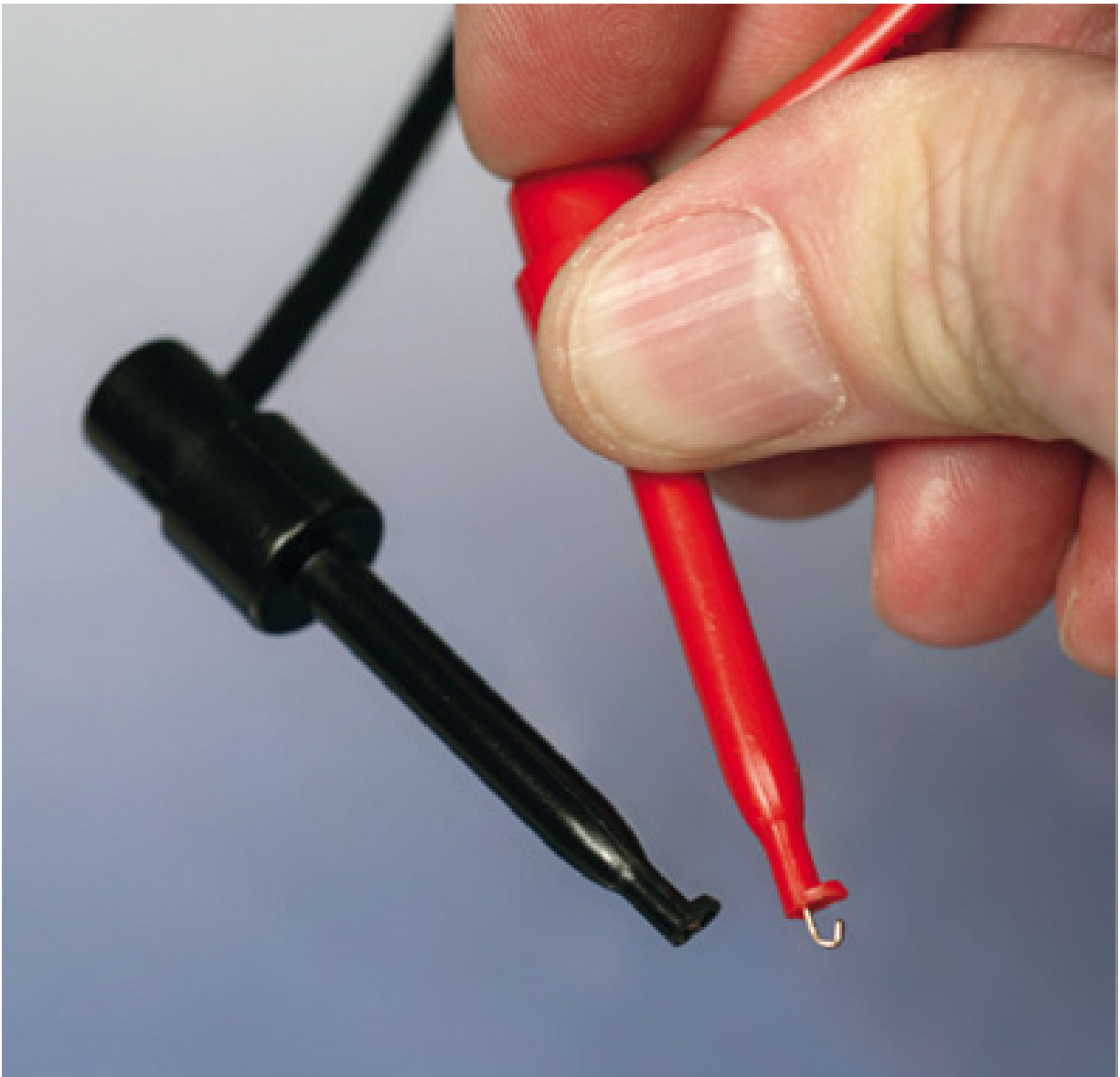
Figura 3.8 – Estas “minigarras” dos cabos servem para se prender aos fios ou terminais de componentes.
