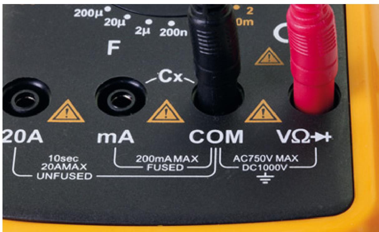
Figura 1.19 – As funções dos soquetes estão divididas de outra forma neste multímetro.
