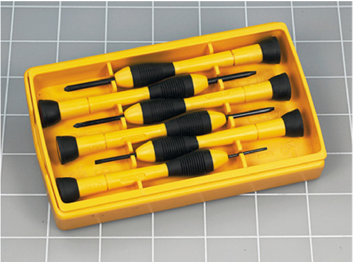
Figura 2.1 – Chaves de fenda pequenas, com pontas planas e pontas Phillips. As linhas brancas estão separadas por intervalos de 1 polegada (2,5 cm).
