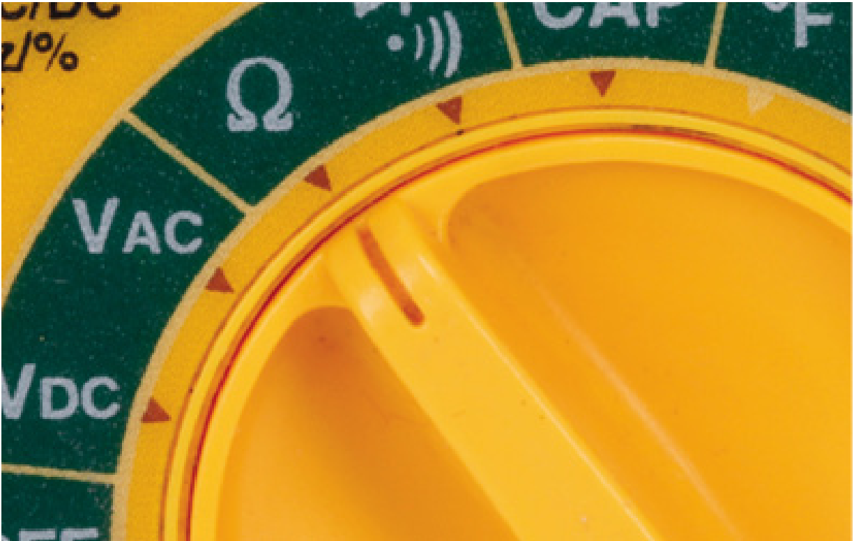
Figura 1.22 – Em um multímetro automático, basta girar o dial até o símbolo ohm (ômega).
