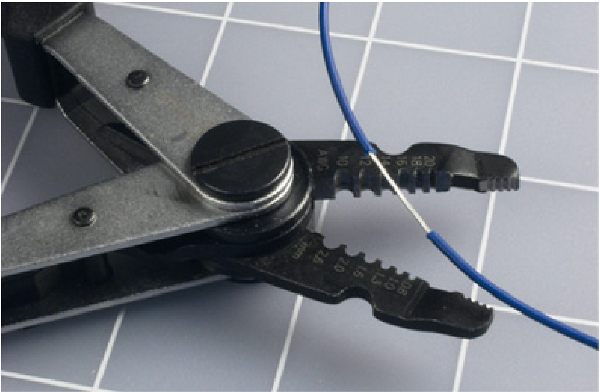
Figura 5.66 – Use seu descascador de fios e polegar para remover cerca de 1,2 cm de isolante.
