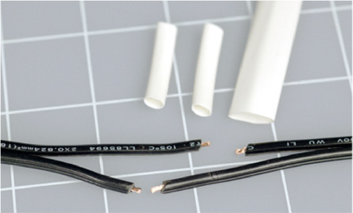
Figura 3.53 – Passo 5 de 12, para encurtar um cabo de alimentação.
