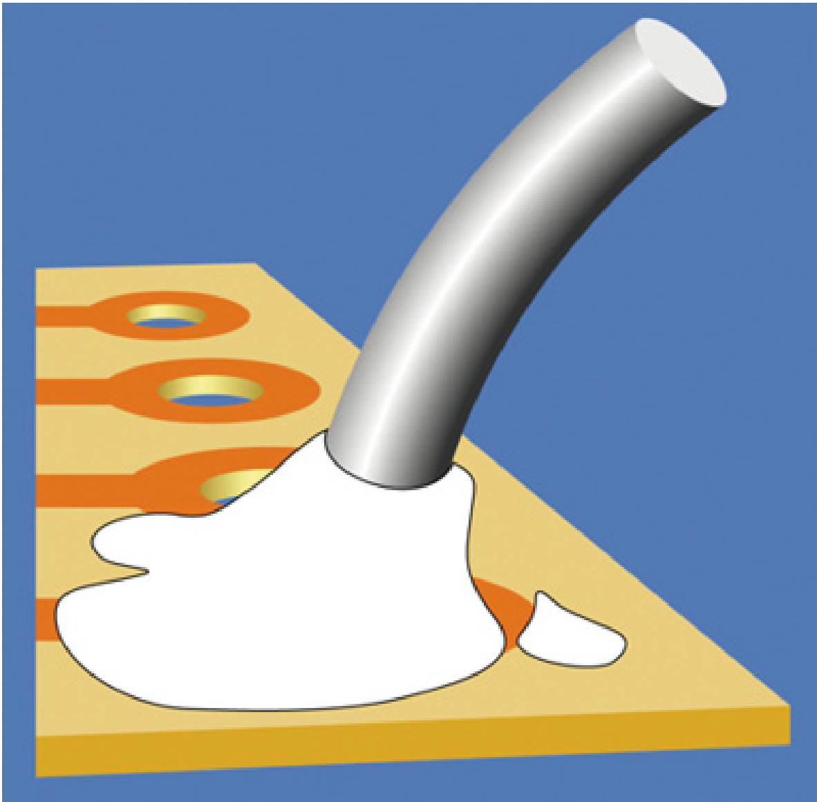
Figura 4.53 – Se você usar solda demais, ela tende a permanecer em locais indesejados.
