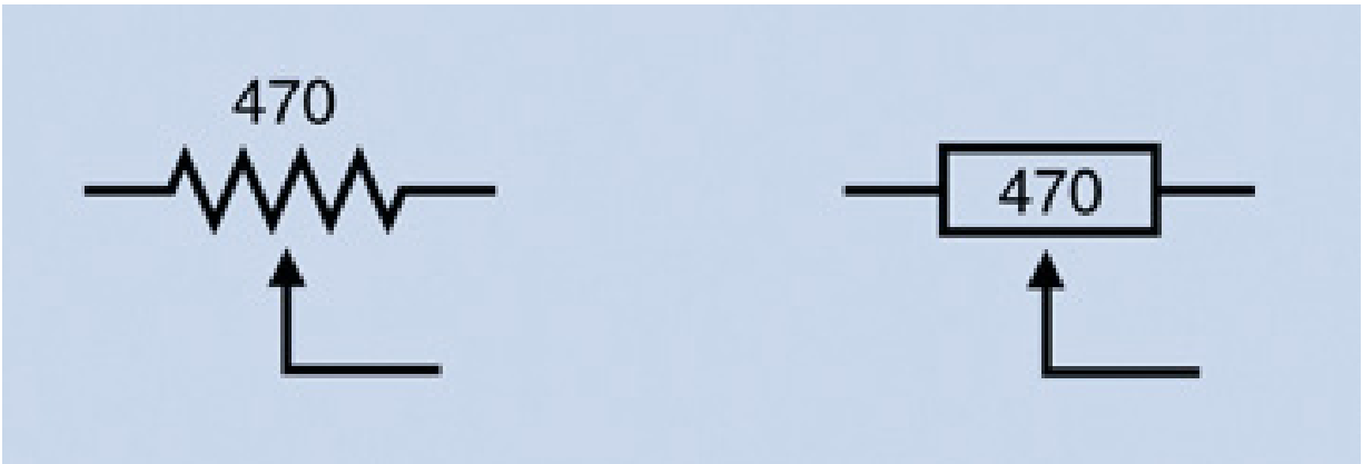
Figura 2.45 – O símbolo à esquerda para um potenciômetro é usado nos Estados Unidos e o símbolo à direita teve origem na Europa.
