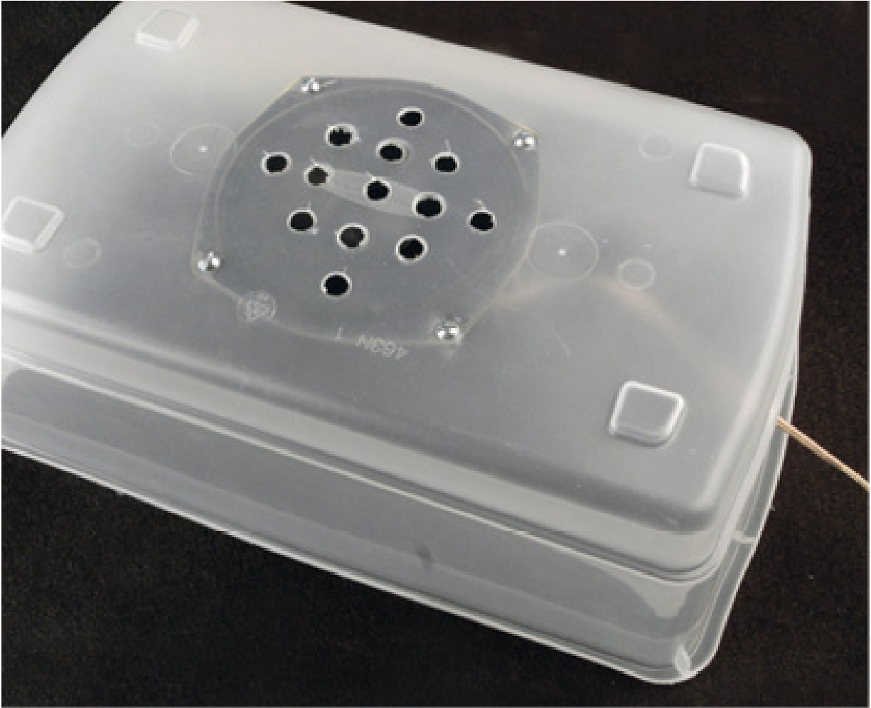
Figura 5.41 – Uma caixa de ressonância é necessária se você quiser ouvir sons graves (frequências menores) de seu alto-falante. Uma caixa de armazenamento de plástico é suficiente para fins de demonstração.
