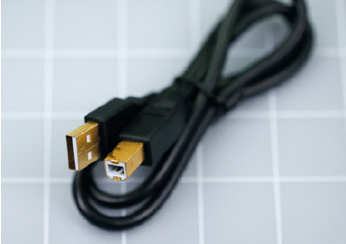
Figura 5.81 – Você precisará deste tipo de cabo USB para ligar sua placa Arduino a uma porta USB de seu computador.
