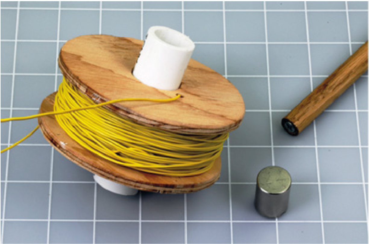
Figura 5.18 – Duzentas voltas de fio 22 AWG em um carretel caseiro, com um ímã que está ligado a um parafuso em uma cavilha de madeira.
