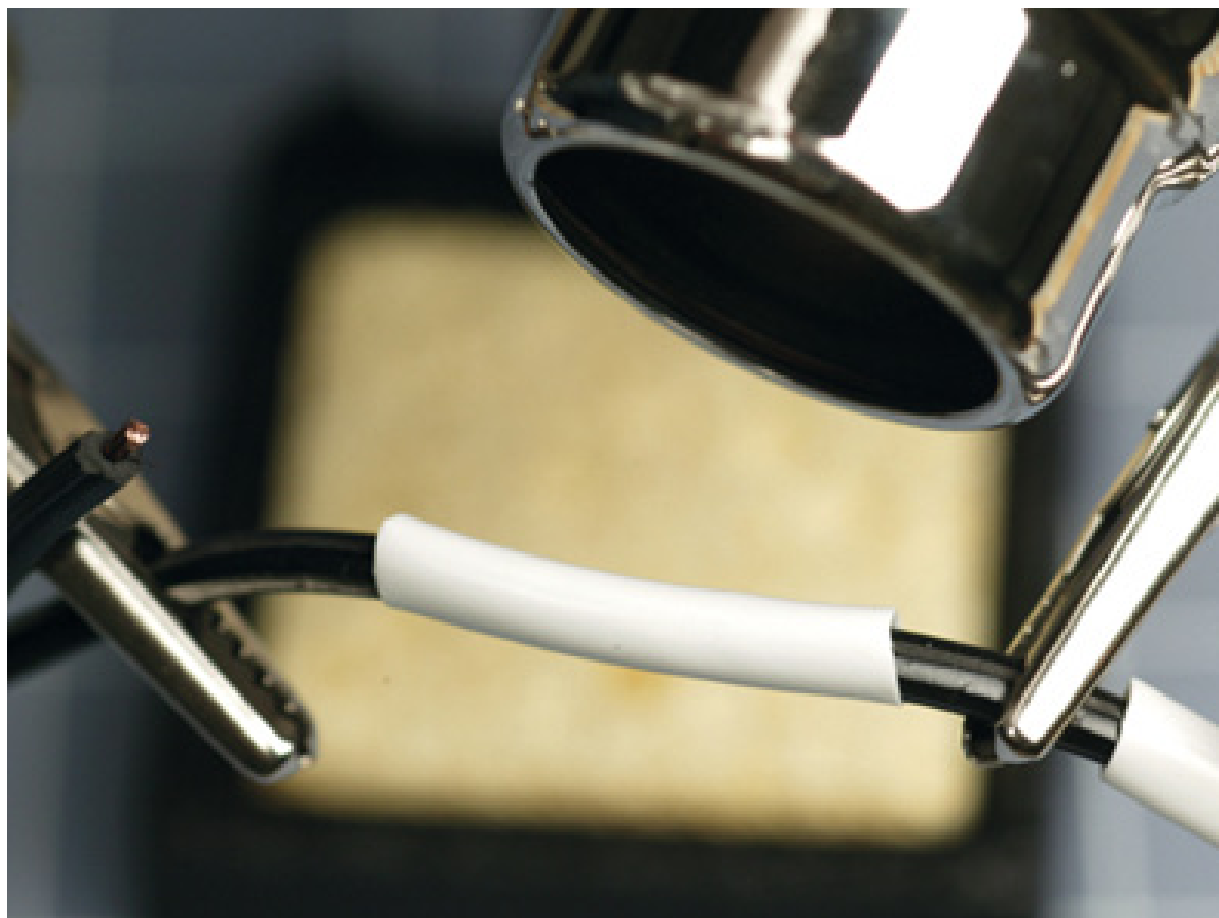
Figura 3.57 – Passo 9 de 12, para encurtar um cabo de alimentação.
