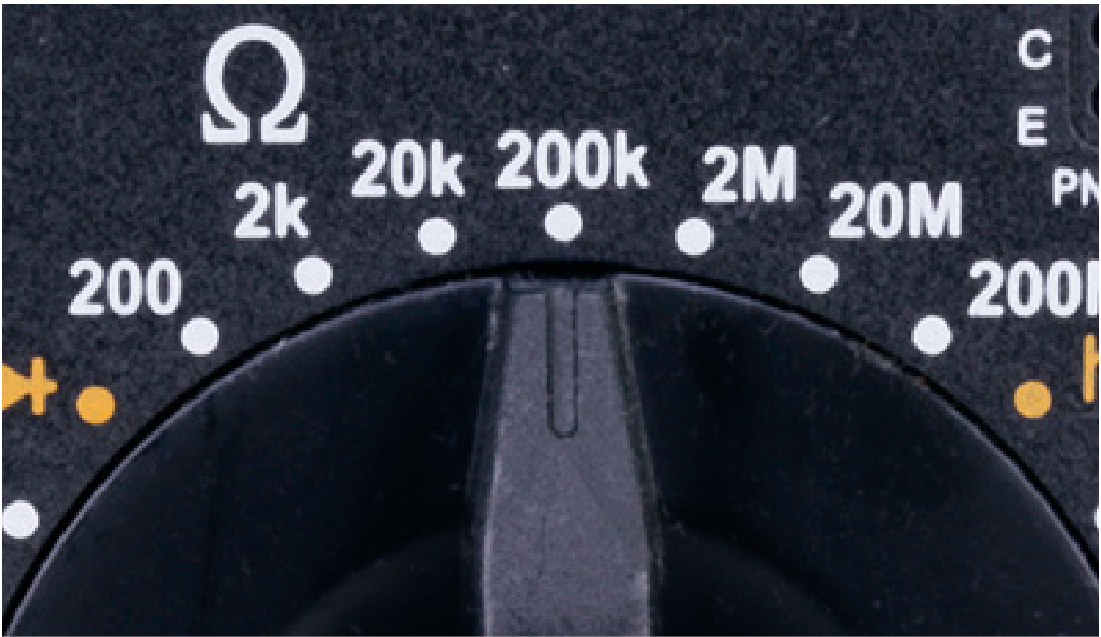
Figura 1.23 – Um multímetro manual requer que você selecione o intervalo.
