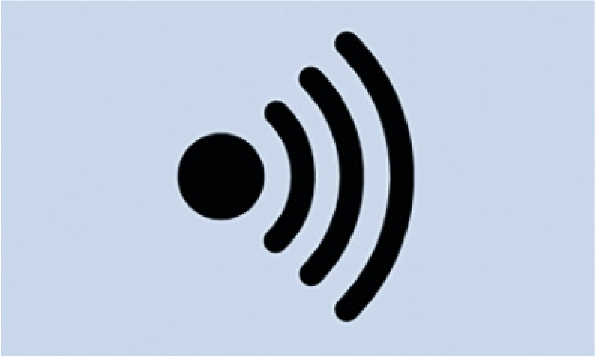
Figura 1.7 – Este símbolo indica a opção de testar a continuidade de um circuito com um feedback sonoro. É um recurso muito útil.
