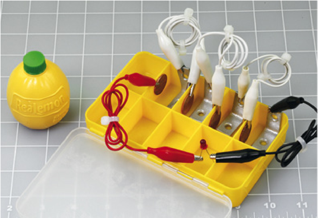
Figura 1.65 – Suco de limão, da própria fruta ou de uma garrafa de suco concentrado, produzirá resultados confiáveis, mesmo que o equipamento não pareça tão legal. Aqui uma caixa para guardar pequenas peças foi transformada em bateria de suco de quatro células.
