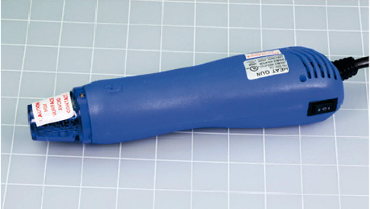
Figura 3.11 – Um soprador térmico miniatura é um pouco mais fácil de manusear do que o tipo maior.
