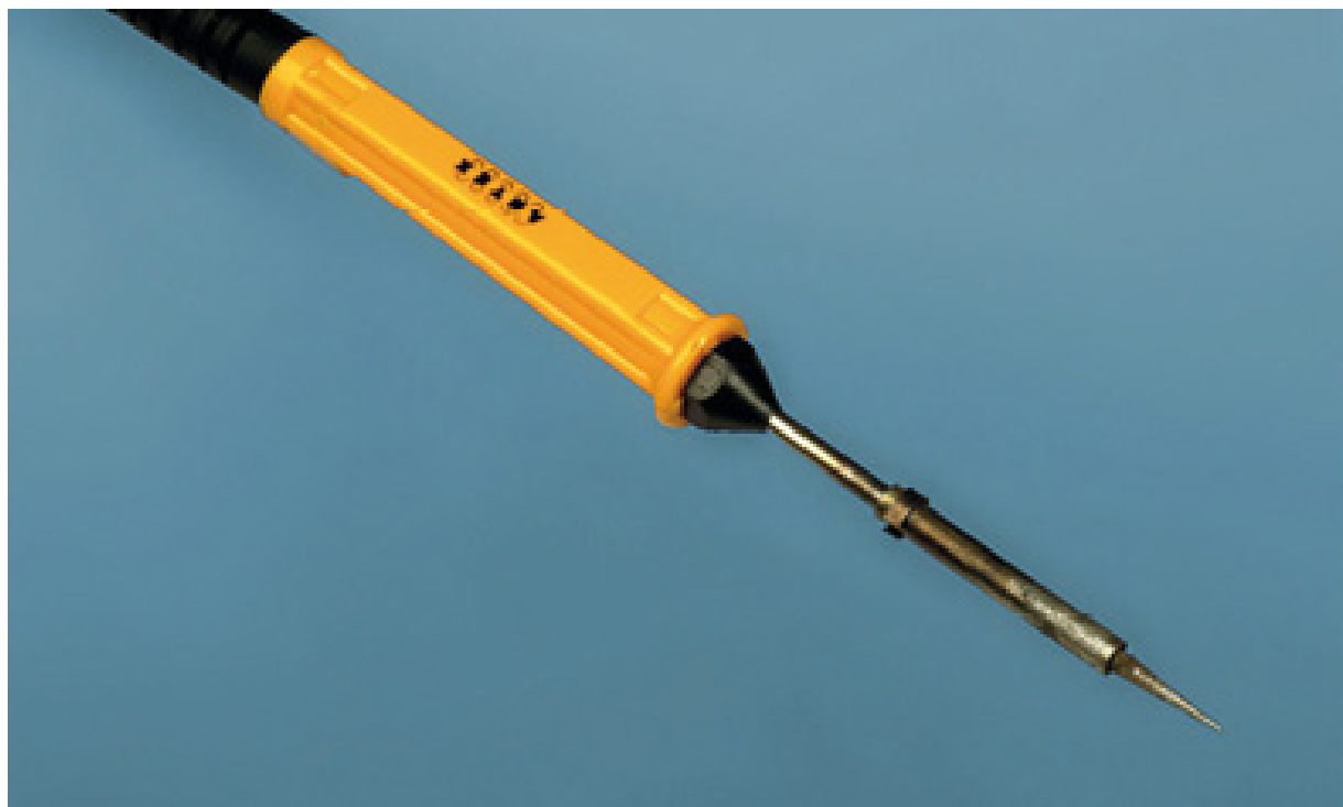
Figura 3.3 – Um ferro de solda de baixa potência projetado para trabalhos precisos em eletrônica.
