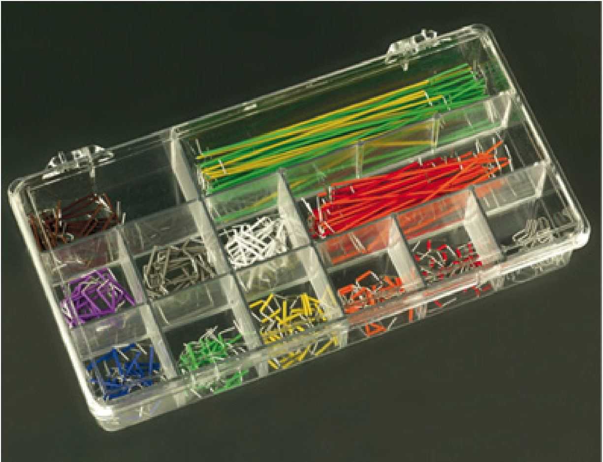
Figura 2.15 – Um sortimento de fios pré-cortados, desencapados e dobrados para uso em uma matriz de contato.
