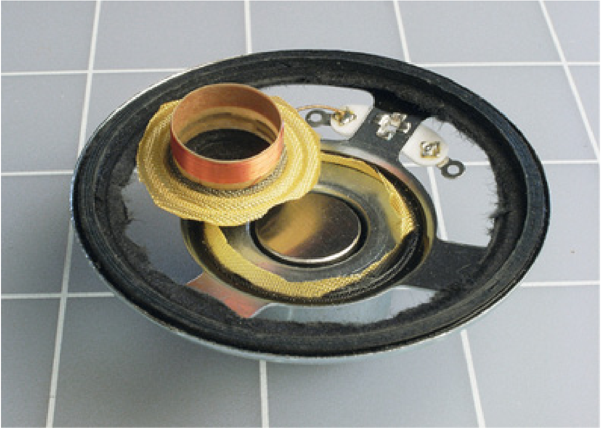
Figura 5.28 – A bobina de cobre é normalmente oculta dentro do sulco do ímã, abaixo.
