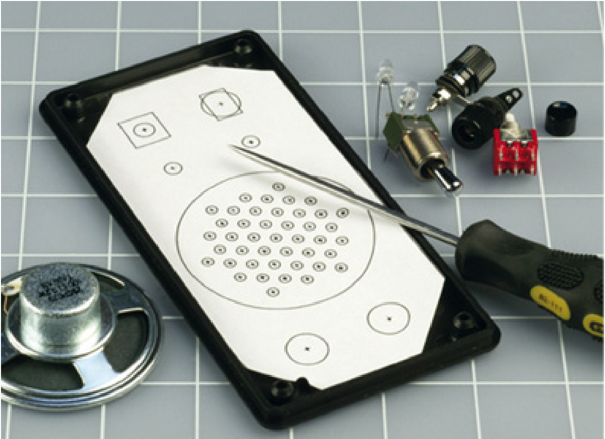
Figura 4.55 – Um layout impresso para os interruptores, LEDs e outros componentes foi grudado na parte de baixo da tampa da caixa de projeto. Um furador é pressionado através do papel para marcar o centro de cada furo a ser feito na tampa.
