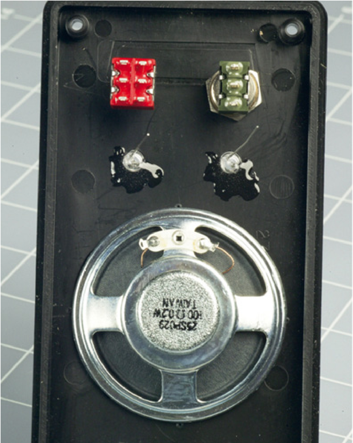
Figura 4.57 – Componentes que foram adicionados ao painel de controle da caixa de projeto (vistos de baixo). O alto-falante foi grudado no lugar. A cola extra foi salpicada sobre os LEDs, só por garantia.
