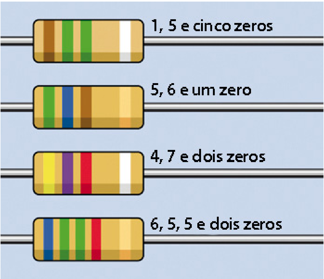
Figura 1.44 – Quatro exemplos de resistores com códigos de cores.
