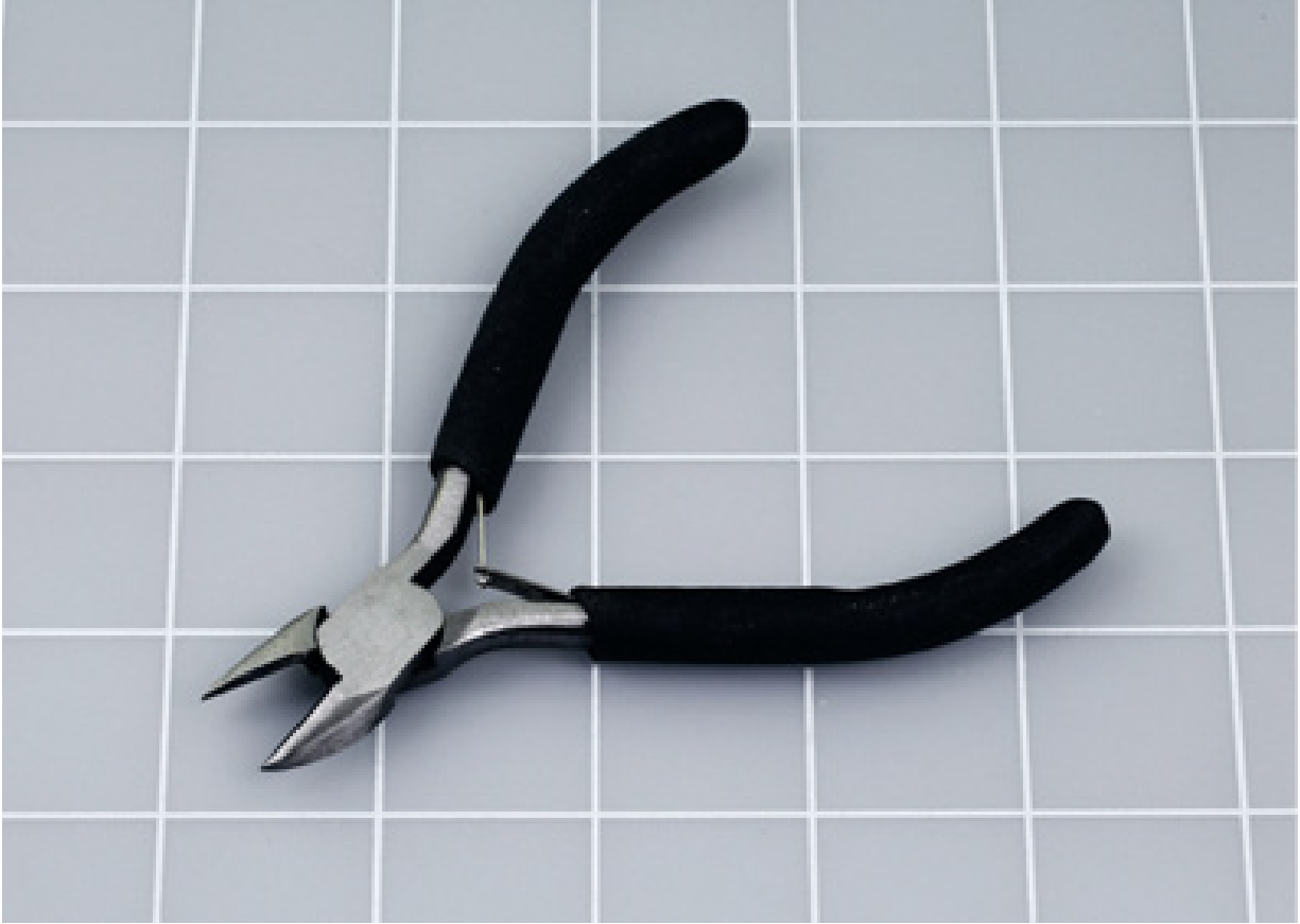
Figura 2.4 – Alicates de corte não devem medir mais de 12 cm.
