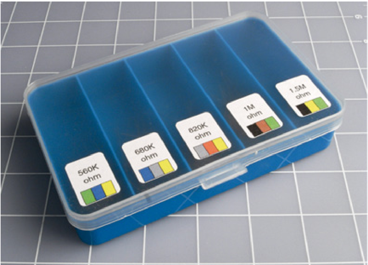
Figura 5.5 – Para verificar se os resistores não estão colocados nos compartimentos errados, imprima o código de cor em cada etiqueta.
