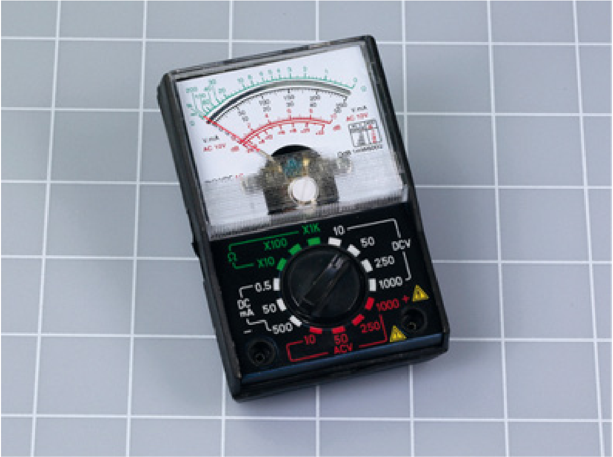
Figura 1.1 – Este tipo de multímetro analógico é inadequado para suas finalidades. Você precisa de um multímetro digital.
