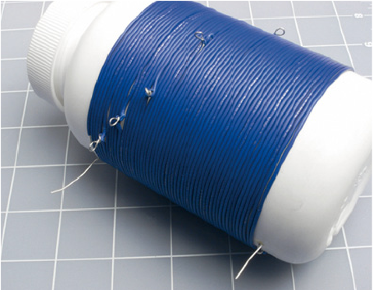
Figura 5.68 – A bobina completa, presa firmemente em torno da garrafa.
