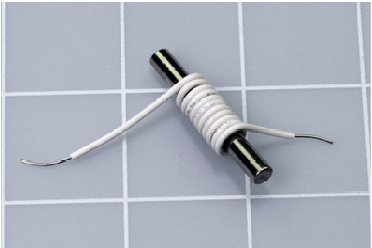
Figura 5.16 – Apenas dez voltas de fio são suficientes para criar um pequeno potencial elétrico quando um ímã se move através dele.
