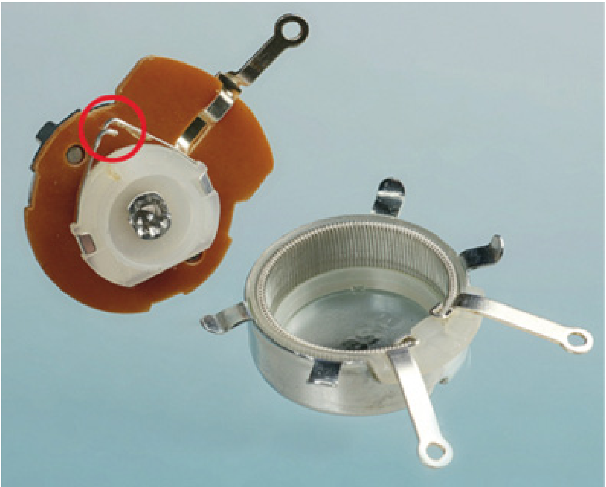
Figura 1.50 – O cursor do potenciômetro é indicado por um círculo.
