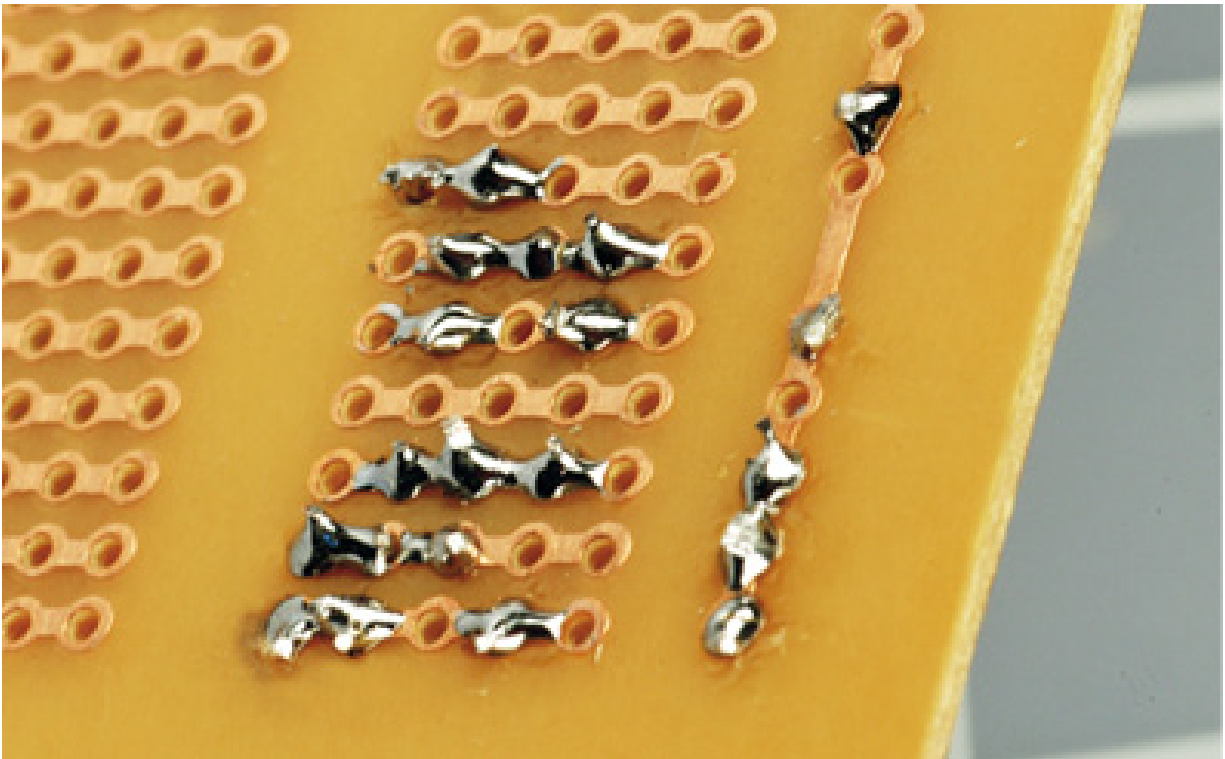
Figura 4.52 – Depois da soldagem, os terminais são aparados e as juntas são inspecionadas por uma lente de aumento. Outros dois ou três componentes agora podem ser inseridos e o processo se repete.
