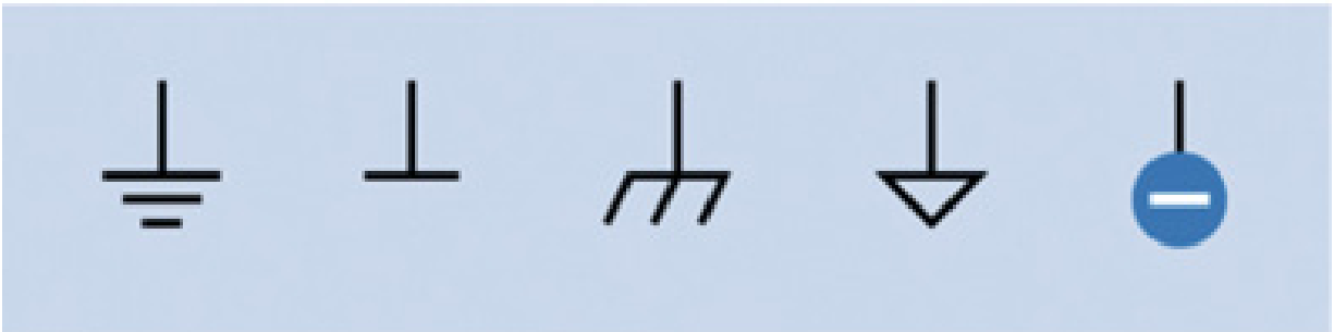
Figura 2.42 – Várias formas de mostrar os terminais positivo e negativo de uma fonte DC em um circuito.
