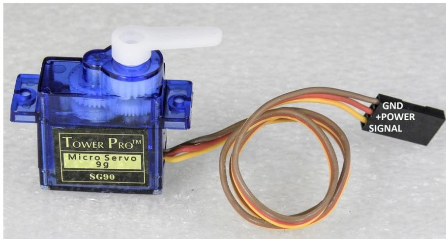
Os Servos são acionados por meio de três fios, dois para alimentação e um correspondente ao sinal de controle para determinar a posição. Em geral, os três fios são:
