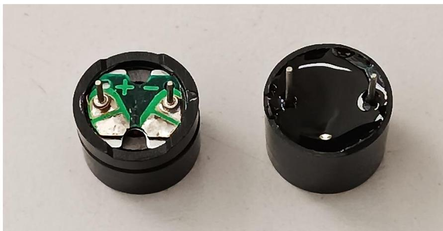
*Buzzer passivo e buzzer ativo, respectivamente*
