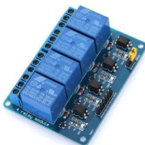
Repare que cada relé possui os três terminais que explicamos mais acima. Além deles, há outros 6 pinos usados para interfacear o módulo com o Arduino. São eles:
