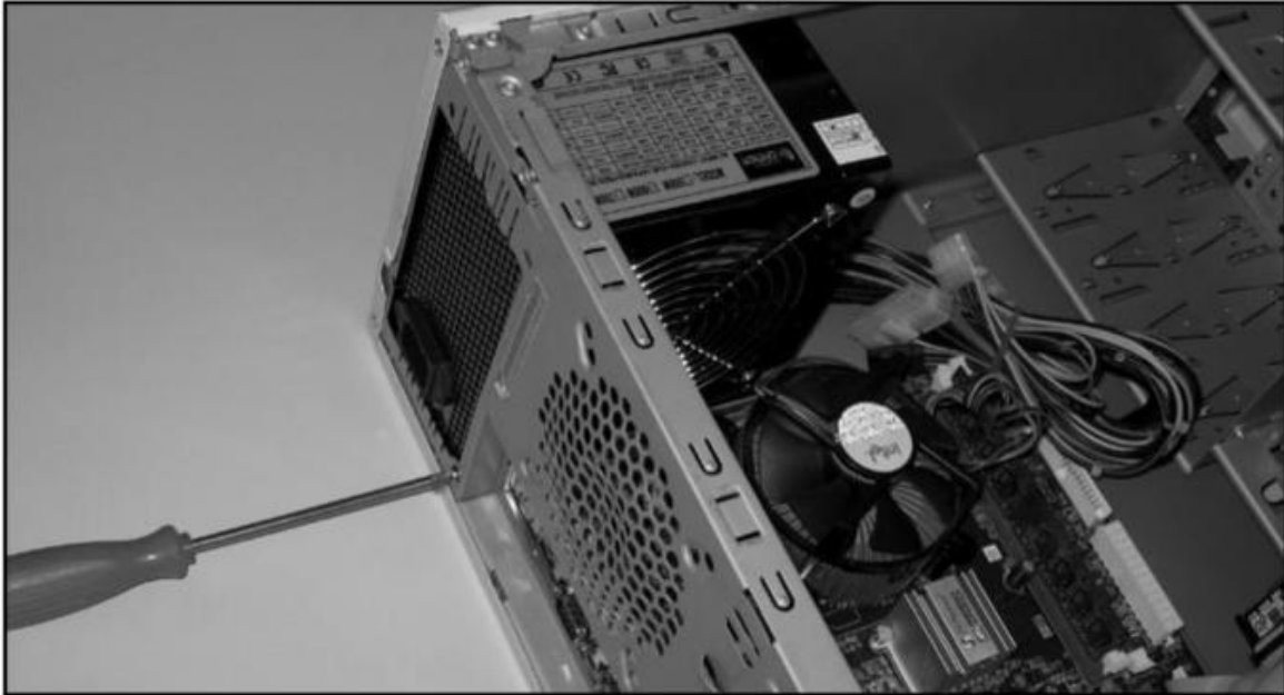
Figura 01.7: Usando a chave Phillips para abrir uma fonte.
