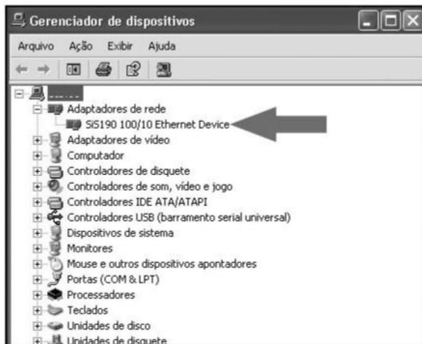
Figura 06.25: Driver instalado corretamente.
