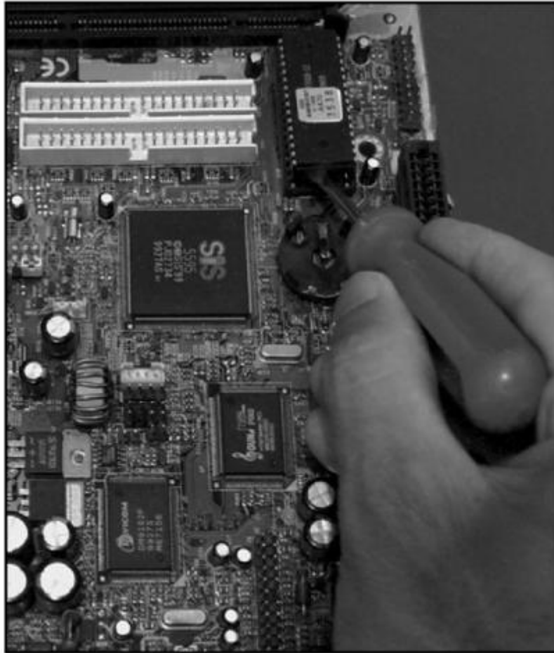
Figura 01.3: Retirando um chip ROM da placa-mãe. Ao fazer isso com a chave de fenda, muito cuidado para não amassar os contatos do chip.
