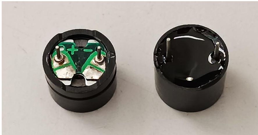
Buzzer passivo e buzzer ativo, respectivamente
